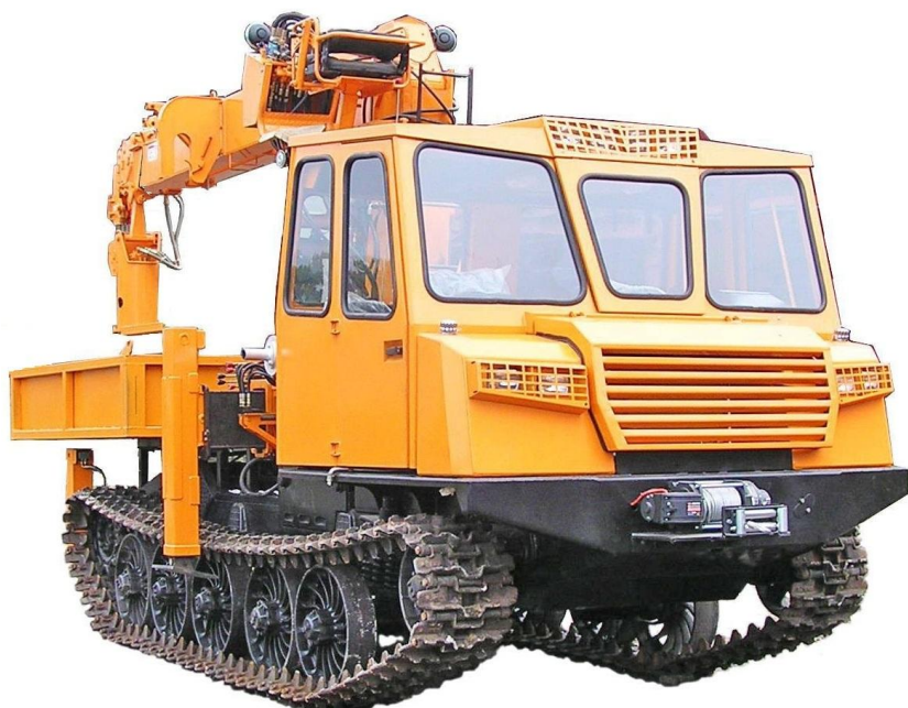
Буровая машина MCH-10-BUER LS с трехместной кабиной оператора
